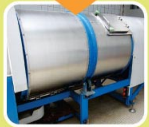
工作人員把廚餘送往及放入廚餘堆肥設備
